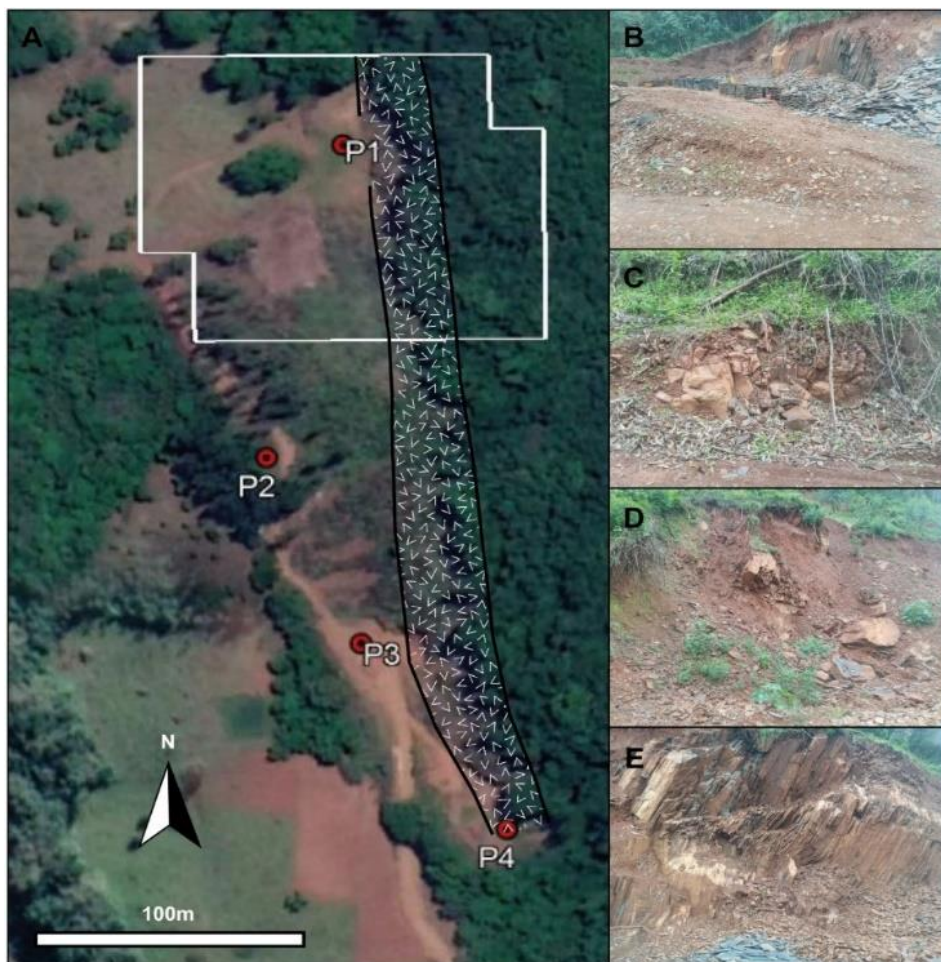
Figura 6: Posição dos quatro pontos de mapeamento geológico utilizados para definição da geometria do corpo de basalto e cálculo do volume da jazida. B) Rocha aflorando na frente de lavra (P1) na pedreira ativa na área do EIA-RIMA. C) Basalto porfirítico aflorando na estrada de acesso a mina (P2). As estruturas, textura e composição da rocha indicam que se trata de um basalto amigdalóide. D) e E) Mostram a estrutura da rocha aflorante (mesma encontrada no P1) nos pontos P3 e P4, respectivamente. A semelhança composicional e estrutural da rocha permitiu desenhar a provável forma do corpo de rocha visto em A).
